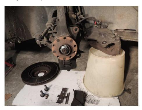
Nettoyez la portée à l'intérieur du disque, montez le disque, fixer le disque de frein au moyeu et le bloquer à l'aide de deux vis placées à environ  $180^{\circ}$  (il n'est pas nécessaire de les serrer au couple).
