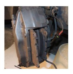
Rebranchez les capteurs d'usure, montez les axes de maintien des plaquettes
